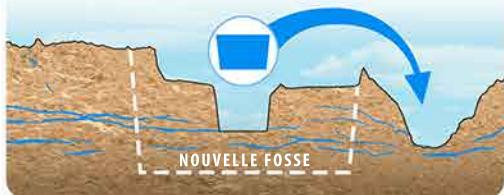
Le vidage de la fosse actuelle est la prochaine étape. Les **120 000 m<sup>3</sup> d'eau** contenus dans la fosse actuelle vont être rejetés et l'eau provenant de la roche devra être pompée en permanence jusqu'à un volume supérieur à 200 000 m<sup>3</sup> par an. Ce pompage forcé va engendrer l'épuisement de la ressource en eau du site aux conséquences inconnues car non évaluées.
